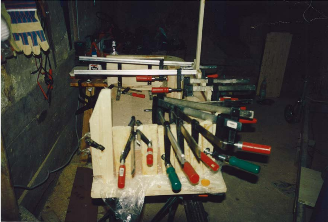
Bild 4: Neubau des hinteren Teils des Süllbords
