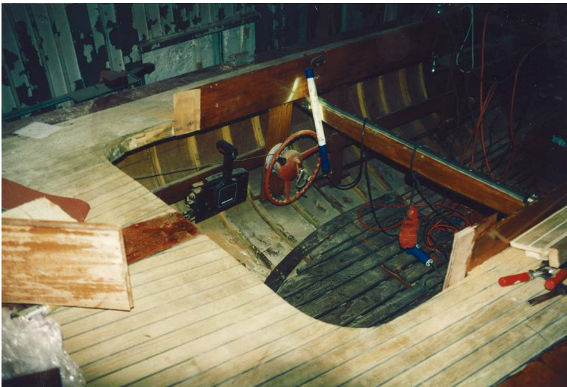
Bild 3: Das hintere Süllbord (verrottet) ist ausgebaut
