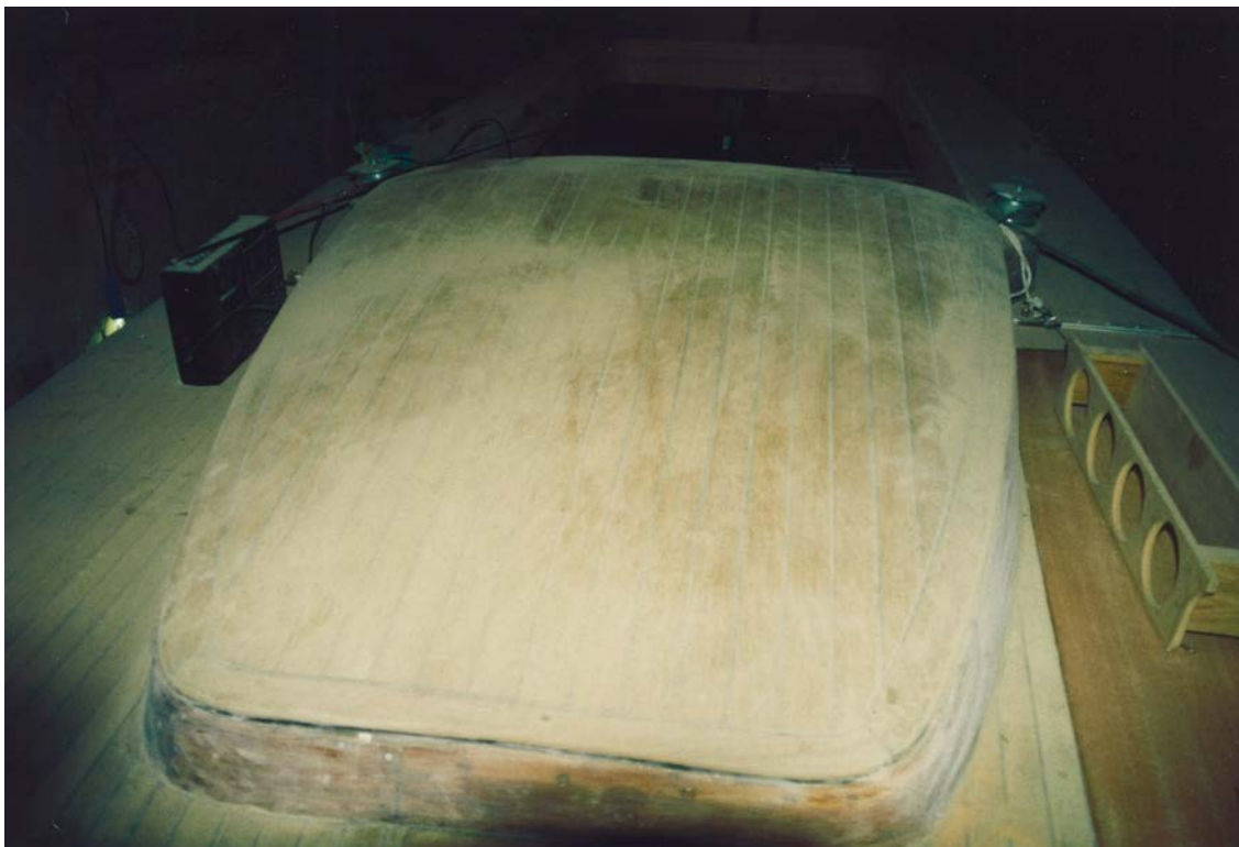
Bild 2: Das neu mit Teak belegte Deck nach dem Schleifen
