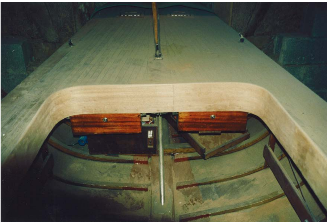
Bild 5: Hinterer Teil des Süllbords eingebaut und beigeschliffen
