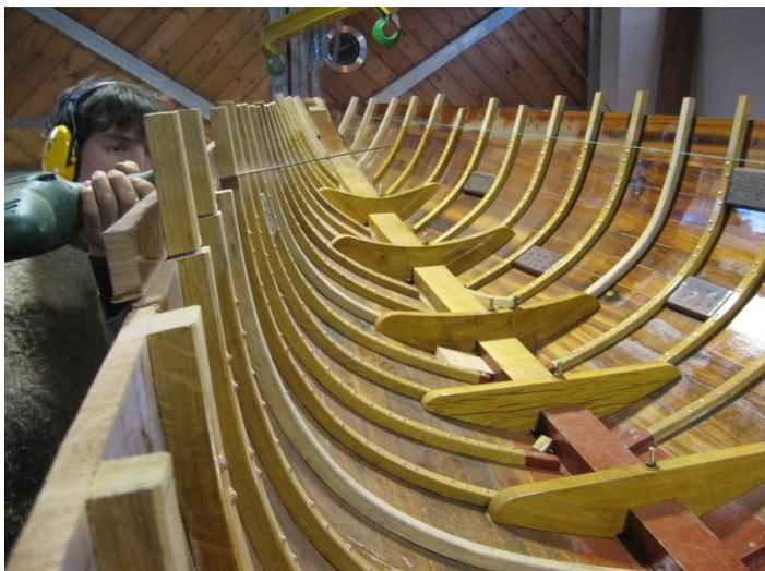
**Bild x: Festlegen der Deckshöhe mit der Tigersäge**
