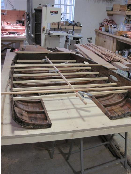
**Bild x: Alte Kajüte „upside down“ mit Lattengerüst fixiert und vorbereitet zur Übertragung der Maße**
