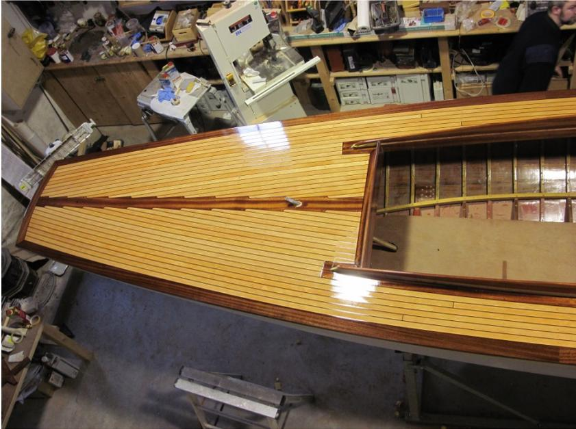
**Bild 41: Deck fertig lackiert**
