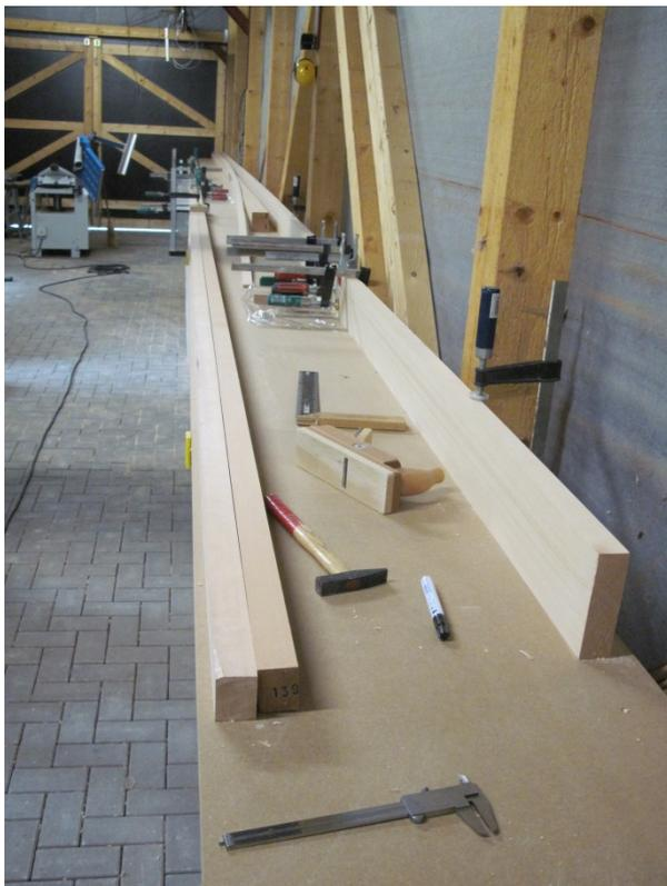
**Bild 46: 12 Meter lange, astfreie Leisten für den Mastbau**
