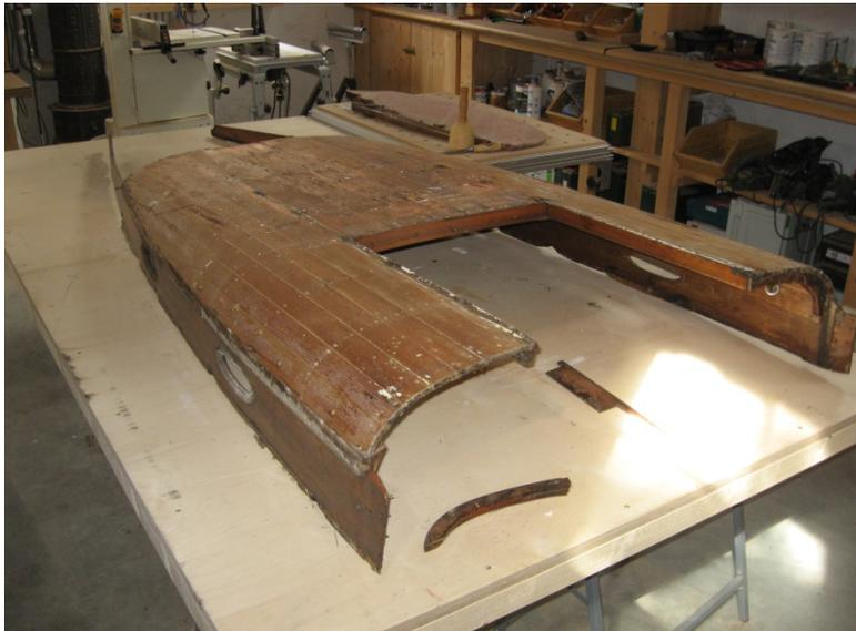
**Bild x: Wrack der Kajüte, teilweise zu Staub zerfallen**
