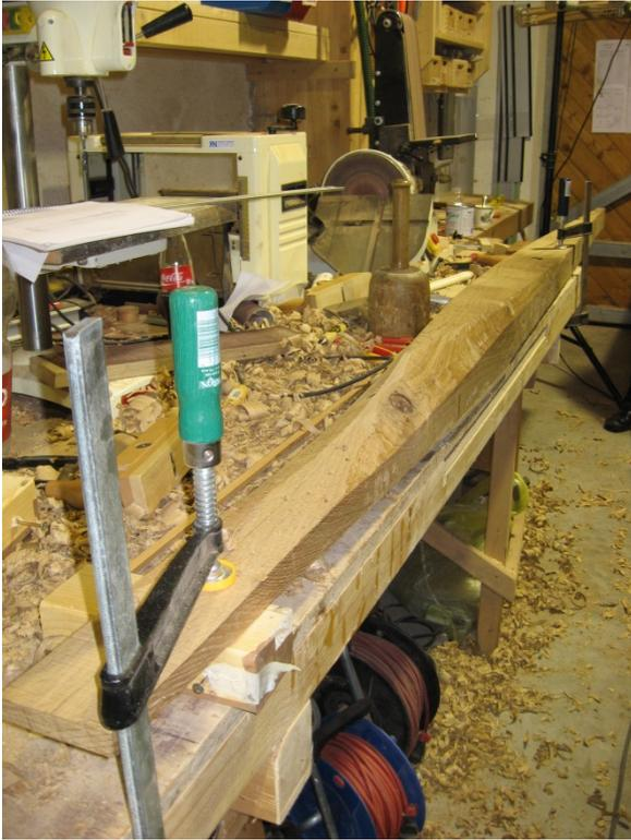
**Bild x: So langsam nimmt der Nachbau der Kielsektion Formen an**
