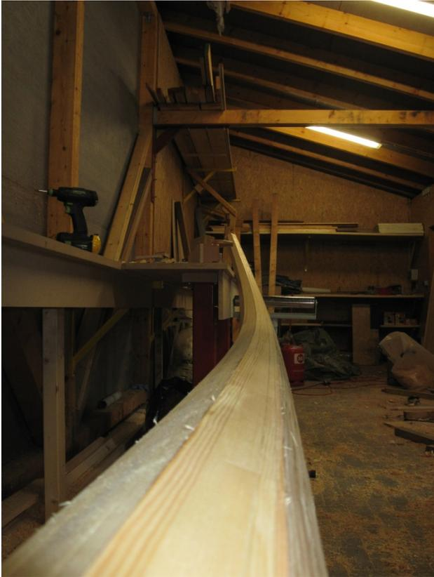
**Bild 48: Aus dem Leistenviereck wird im ersten Schritt eine Achteck gehobelt ...**
