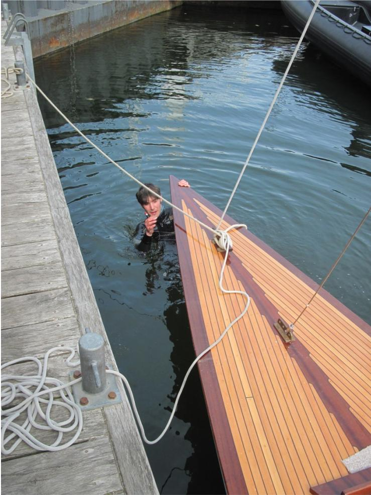
**Bild 53: Ermittlung des Wasserpasses**
