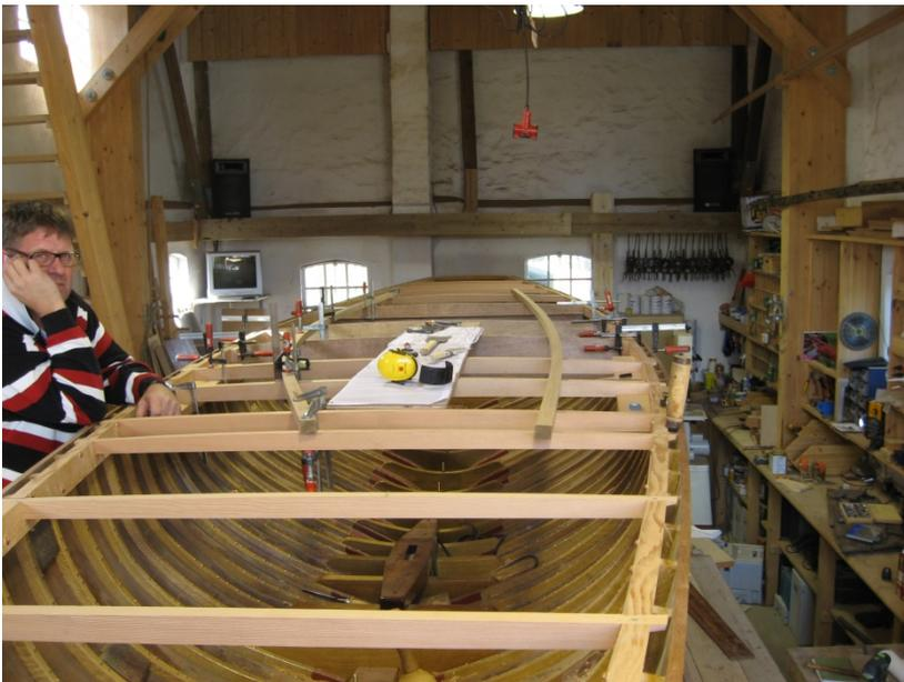
**Bild x: Erste Decksbalken montiert, Schlingen im Rohbau. Der Besitzer: ob das jemals wieder ein Schiff wird?**
