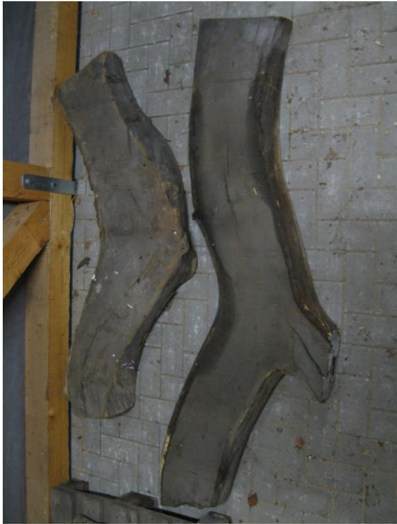
**Bild x: Rohmaterial: Das werden Bodenwrangen**
