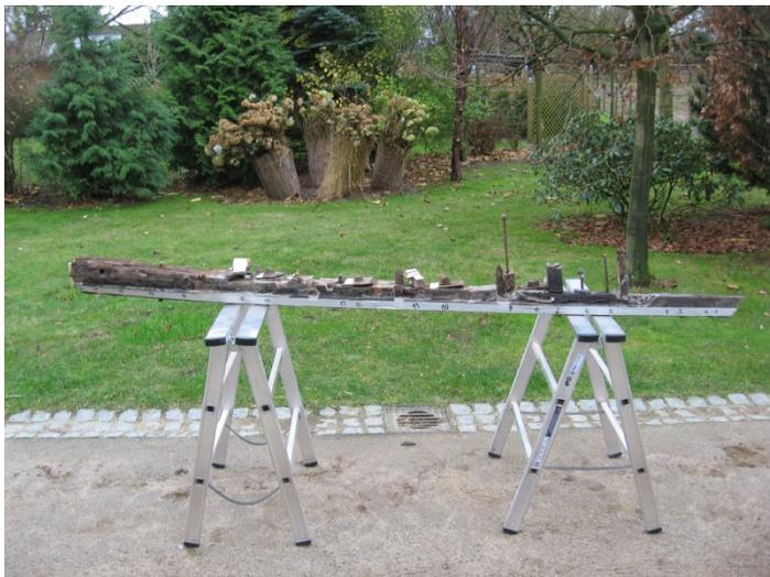
**Bild x: Die „herausoperierte“ Keilsektion, tatsächlich wohl nicht mehr geeignet, 0,7 Tonnen Bleiballast zu tragen**
