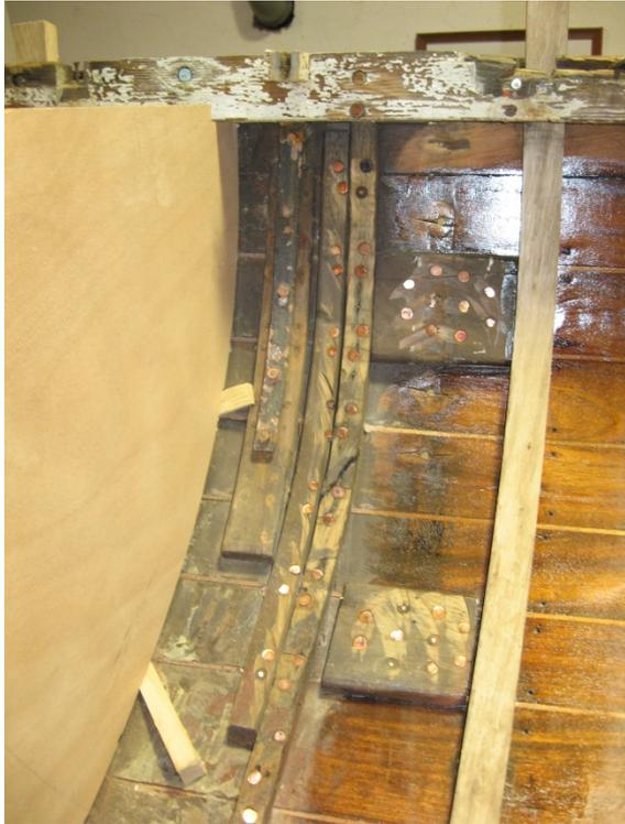
**Bild x: Alte Spanten und neu eingebogenes Spant (rechts) in trauter Nachbarschaft**
