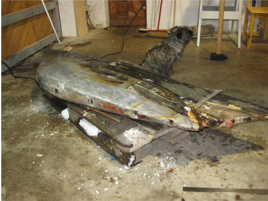
**Bild x: Bleiballast mit Totholz (nicht nur der zufällig anwesende Hund wandte sich angewidert ab und schüttelte den Kopf).**
