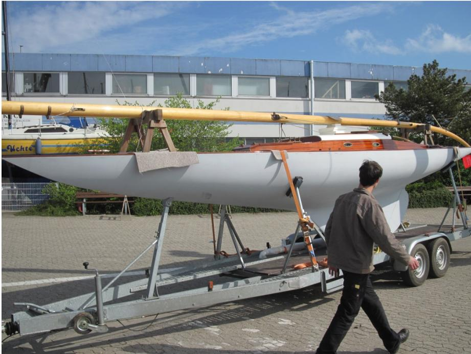
**Bild 51: Freya, Rumpf grundiert, Deck fertig lackiert, auf dem Weg zurück in ihr Element**
