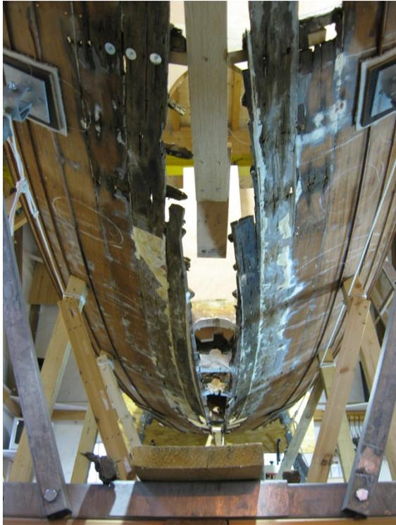
**Bild x: Kielsektion von unten nach Entfernen des Kielbalkens. Ob das jemals wieder wird?**
