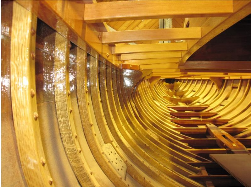
**Bild 37: Spanten, Balkweger, Mastfuß (rechts unten), Decksbalken und Knie montiert**
