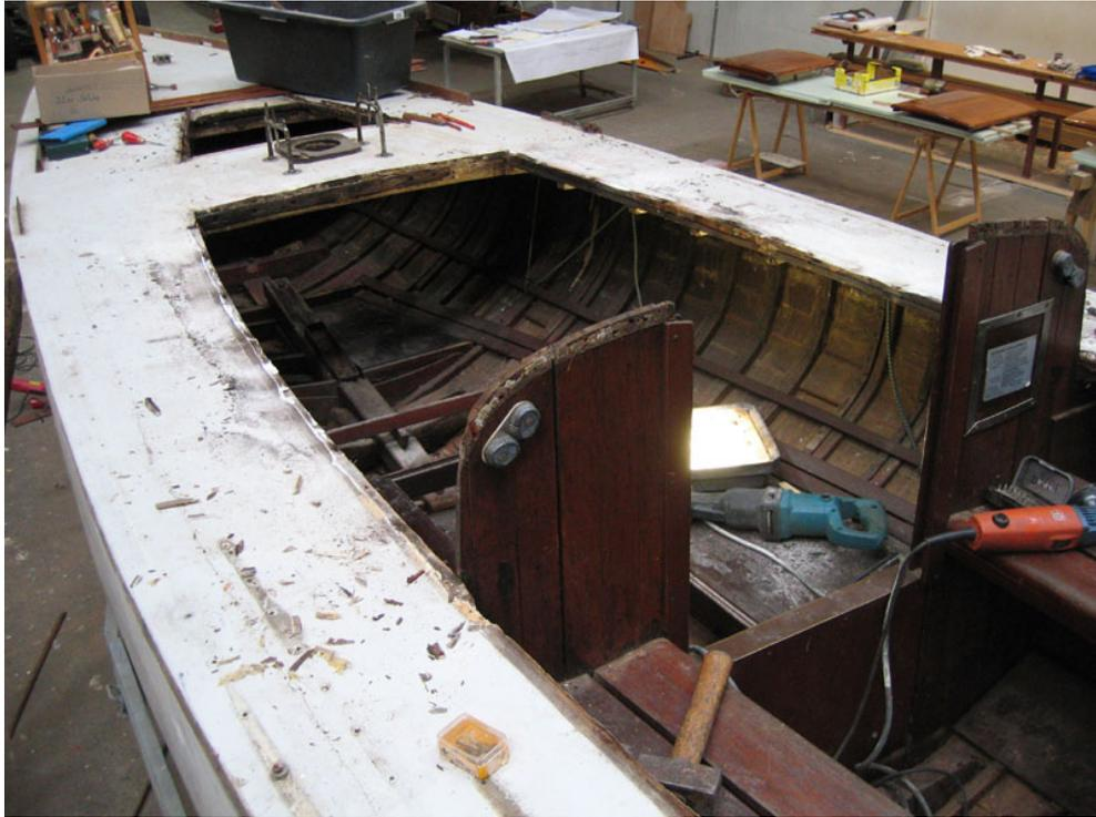
**Bild x: Beschläge und Kajüte abgebaut**
