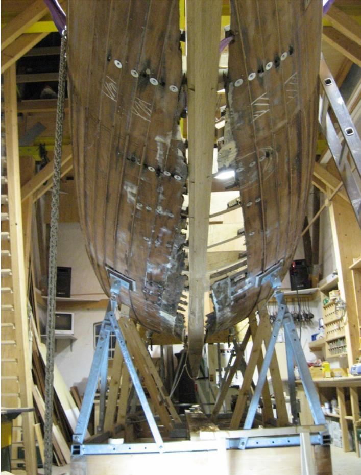
**Bild x: Kielsektion neu montiert, verfaulte Plankengänge entfernt**
