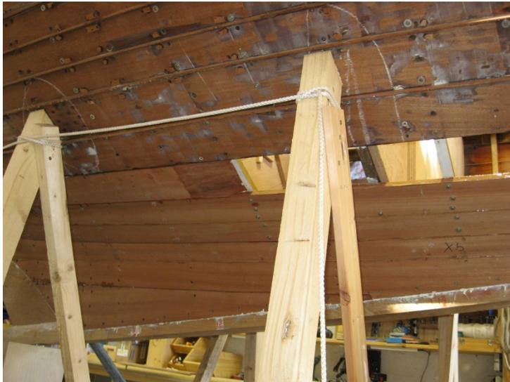
**Bild x: Einbau der unteren Planken**
