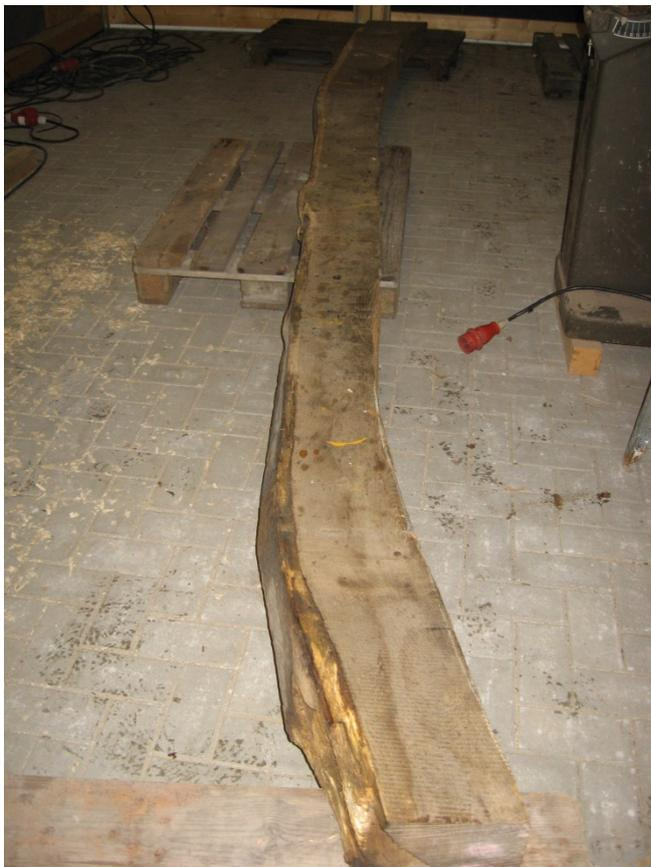
**Bild x: Rohmaterial: Passende Bohle für die Kielsektion**
