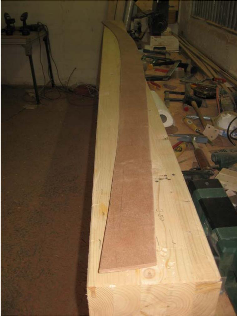
**Bild 12: Bananenform der fertigen Planke**
