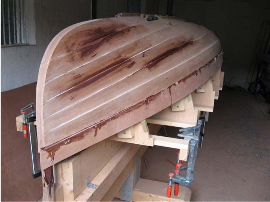
**Bild 13: Vor der Montage der letzten Planke, das Schleifen hat schon begonnen (der Bug ist schon fertig geschliffen)**
