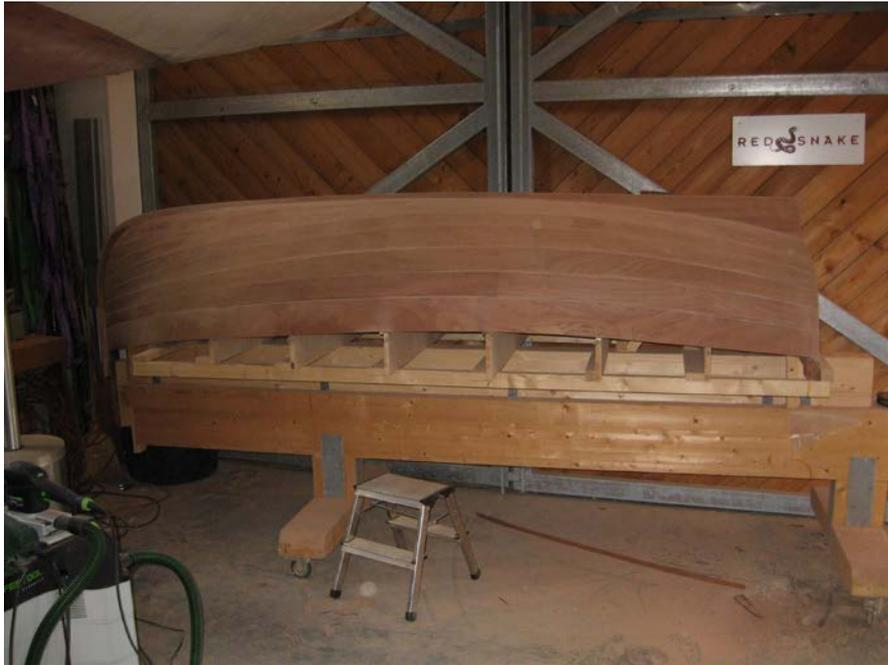
**Bild 15: Das Planken ist endlich abgeschlossen, Rumpf ist außen geschliffen**
