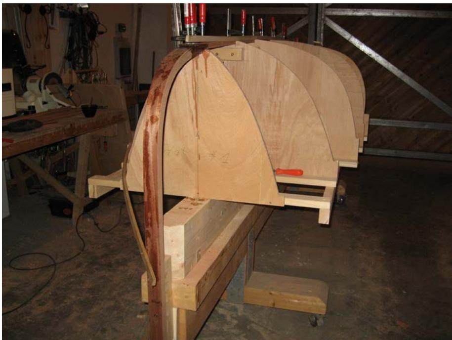
**Bild 6: Montiertes Kielschwein zusammen mit dem angeschäftetem Bug-Innenstevens**
