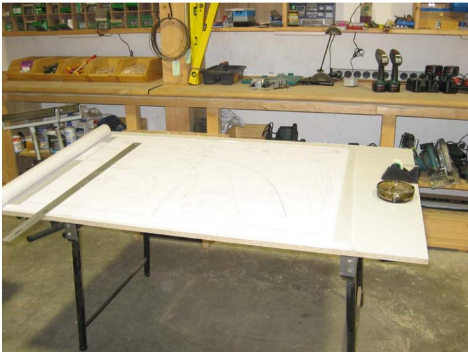
**Bild 2: Übertragung der Spantenpläne auf die Mallen**
