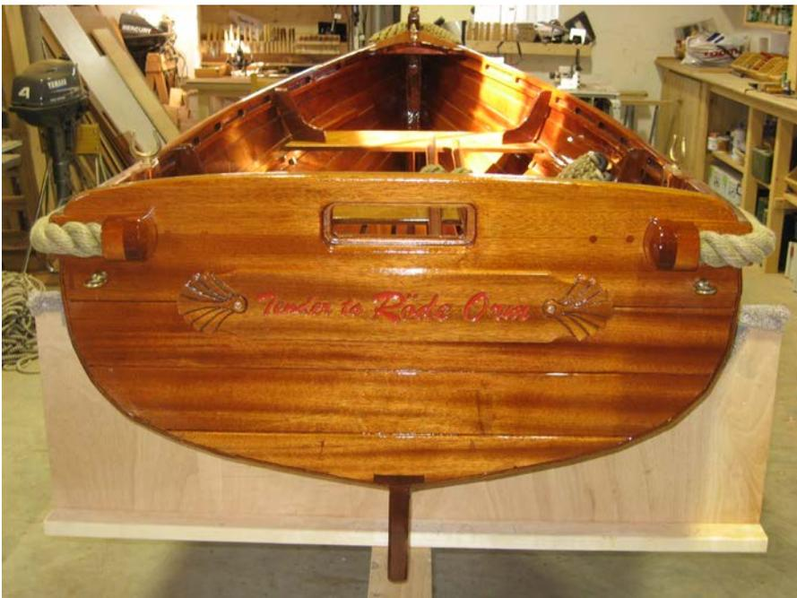
**Bild 27: Gedrehter hölzerner Tauwerkabschluss und geschnitztes Namensschild**
