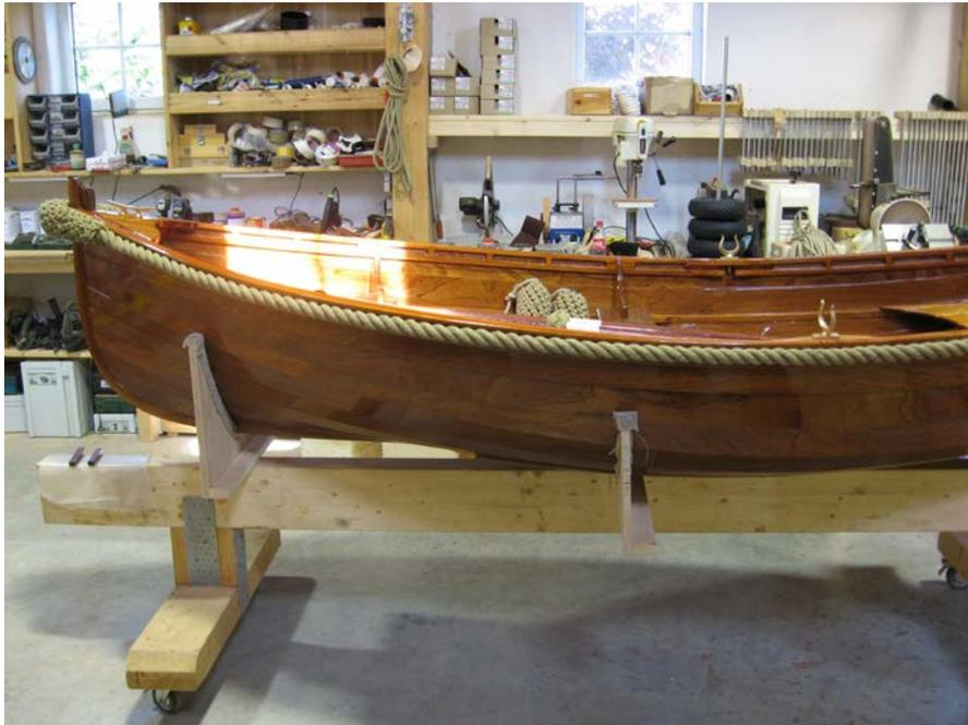
**Bild 23: Sieben Schichten Klar-Bootslack, alle Beschläge neu montiert**
