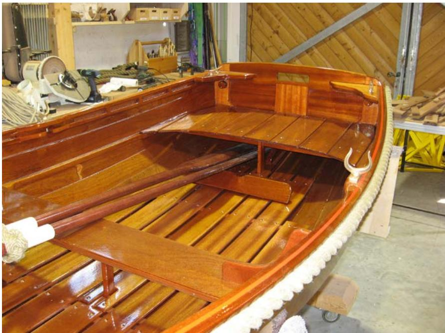
**Bild 25: Umlaufendes Tauwerk als Rammschutz (wie das wohl befestigt ist?)**
