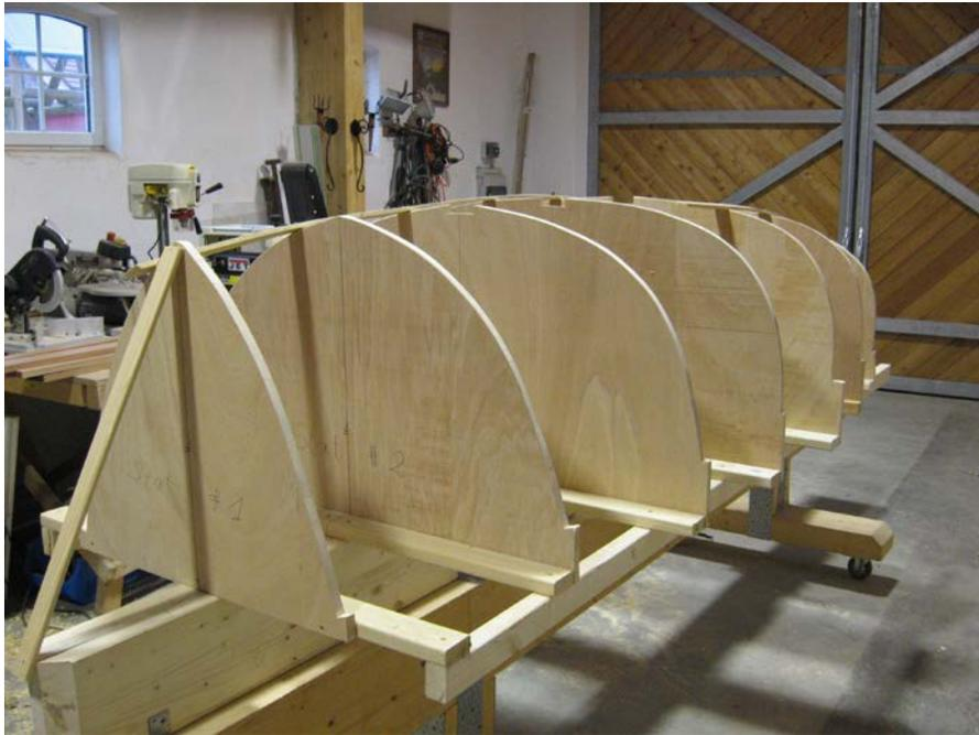
**Bild 3: Montage der Mallen auf dem Helgen**
