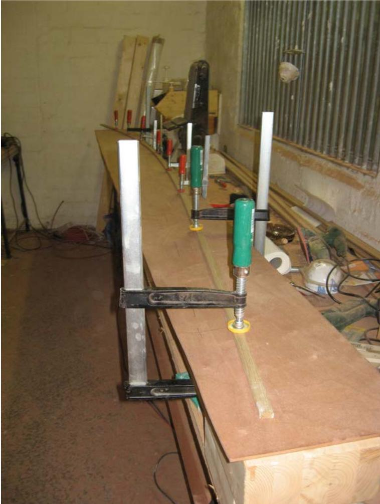
**Bild 11: Ausstraken der vorher vom Mallengerüst abgenommenen Messpunkte der Plankenstöße**
