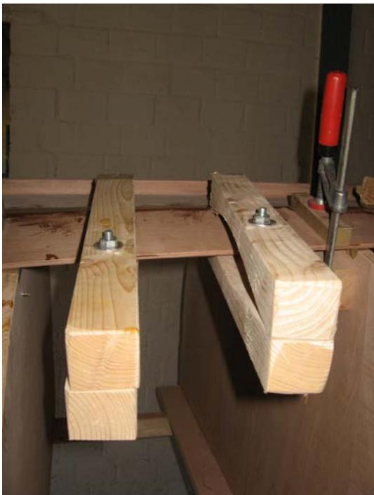
**Bild 9: Plankenmontage und –verklebung mit „Spezialwerkzeug“**
