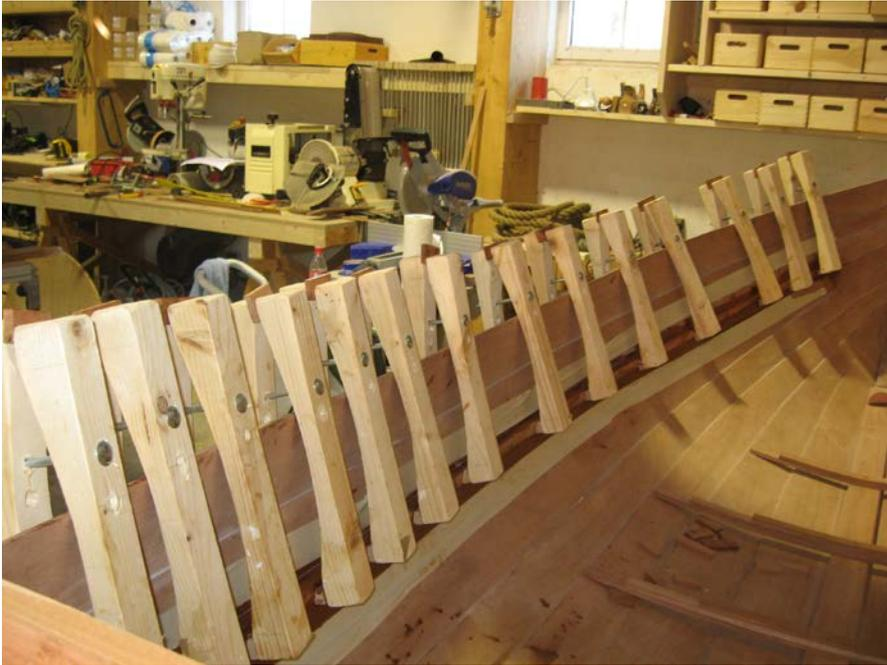
**Bild 17: Montage der inneren Leiste, auf der die Ruderbänke aufliegen.**
