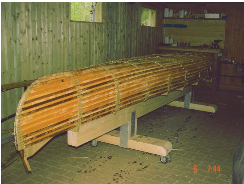
Bild 8: Leisten verklebt, Fixierungsnägel noch nicht gezogen
