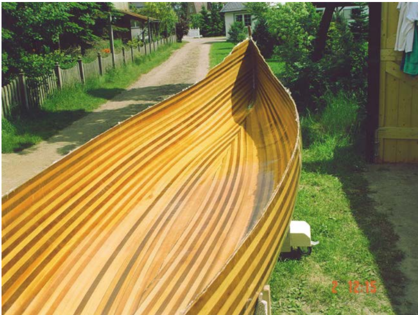
Bild 12: Kanu in Schwimmlage, Innenlaminat fertiggestellt
