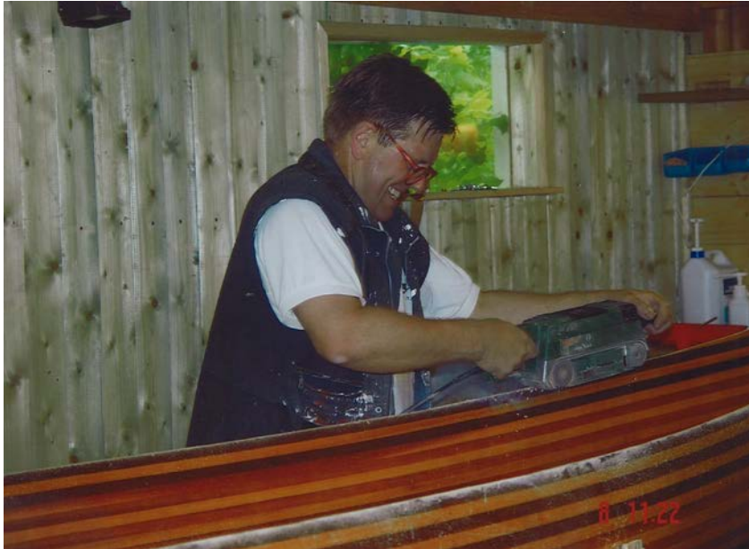
Bild 13: Schleifen der Kanten
