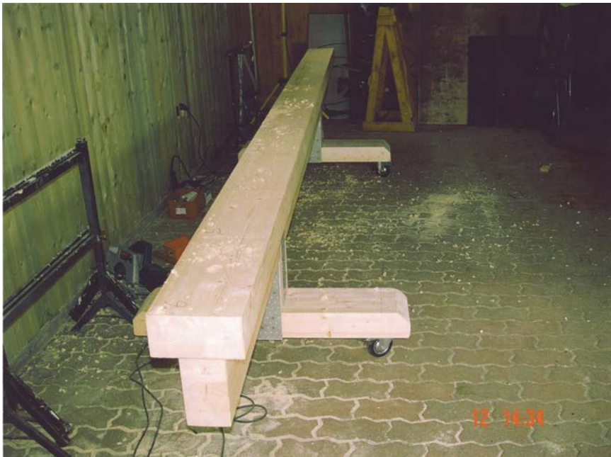
Bild 5: Das fahrbare Mallengerüst
